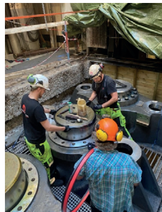
Nye sylindre løftes på plass. Montører og teknikere setter samme presspakninger på pressa.
