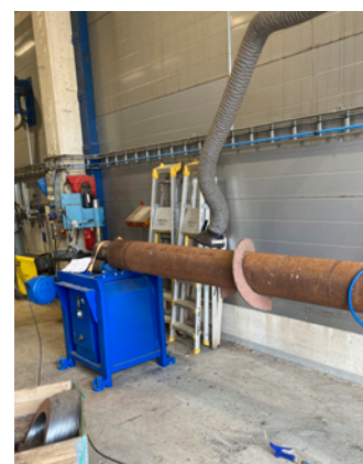
Bilde: Skruer for utmatning av kutterspon produsert ved vedlikeholdsavdelingen med egenutviklet sveisejigg.
