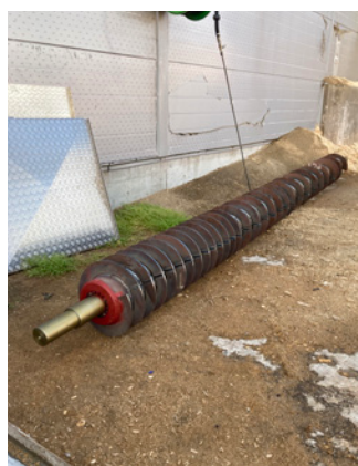
Bilde: Skruer for utmatning av kutterspon produsert ved vedlikeholdsavdelingen med egenutviklet sveisejigg.
