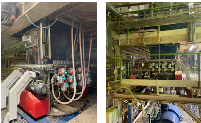
Bilde: Ny transportør for råspen er produsert ved Forestia i sommer og denne ble montert under sommervedlikeholdet.
