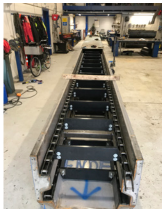
Bilde: Ny transportør for råspen er produsert ved Forestia i sommer og denne ble montert under sommervedlikeholdet.
